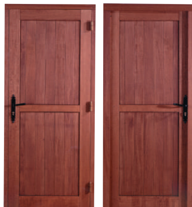
Porte de service Exotique : cadre de 32 mm , panneaux frises verticales ép. 27 mm , ferrage par paumelles, poignée fournie, serrure 3 points encastrée
