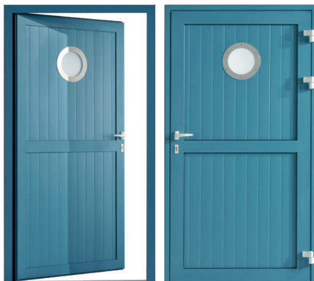
Modèle porte à rupture de pont thermique : cadre 50 mm, panneaux à rainures, ferrage par paumelles. Poignée en standard, quincaillerie blanche et hublot rond Alunox en option, serrure 5 points latéraux Coloris : bleu turquoise RAL 5018
